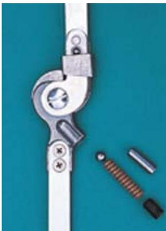
SPEX膝継手の構造
